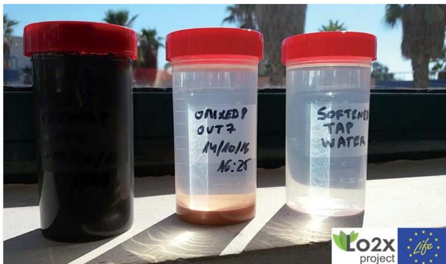
Figura 6. Muestras del experimento llevado en la planta LIFE Lo2x (EDAR de Paterna). Izquierda: Lodo EDAR a tratar; Centro: Efluente; y Derecha: Agua potable descalcificada
